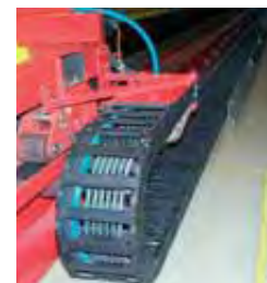
CF5/CF6 w urządzeniu do obsługi regałów wysokiego składowania: długa droga przemieszczenia w osi wzdłużnej. e-prowadnik: Serie E4/00
