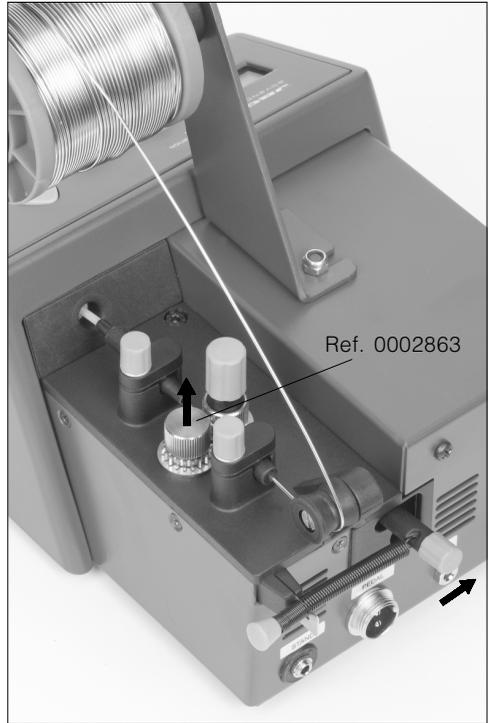
Conecte el lápiz a la estación y pongala en marcha. Pulse en el botón WIRE LOAD (avance rápido del hilo) hasta que salga estaño por el extremo del tubo guía. En el display se muestra el mensaje "CARGANDO HILO SOLDADURA".
