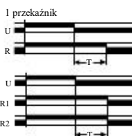
2 przekaźniki zwłoczne lub 1 przekaźnik zwłoczny i 1 bezzwłoczny
