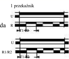
2 przekaźniki zwłoczne lub 1 przekaźnik zwłoczny i 1 bezzwłoczny
