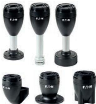
Die neuen Signalsäulen können auf 9 verschiedenen Arten flexibel montiert werden. Neben einer Seitenmontage gibt es verschiedene Möglichkeiten die kelchförmige Basis direkt zu montieren, sowie unterschiedlichste Arten der Rohrmontage. Rohre in den Längen 100, 250 und 400 mm machen den Anbau noch flexibler.
