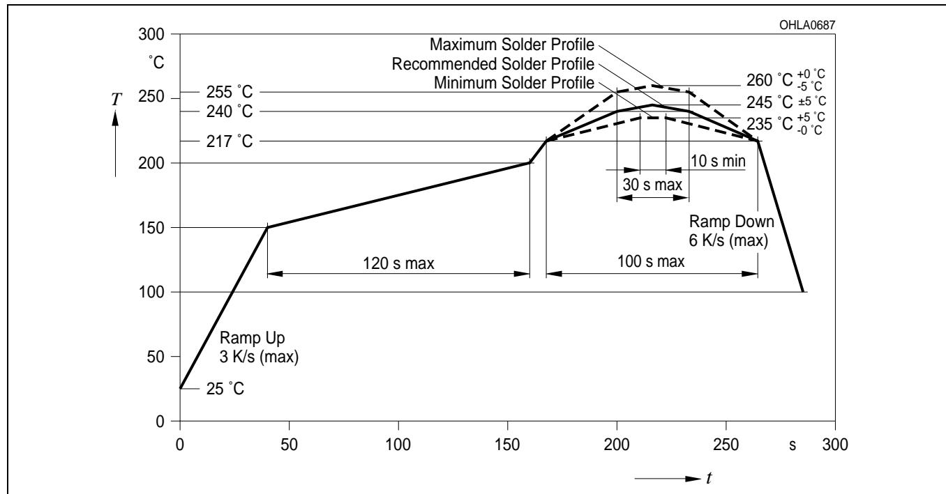
**Wellenlöten (TTW)****TTW Soldering**
