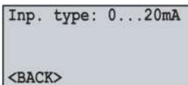
Rysunek 7.2.6. Ekran ustawienia czujnika prądu analogowego
