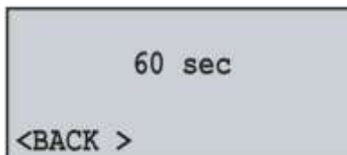
Rysunek 7.8.3. Ekran ustawienia limitu czasu połączenia do serwera
