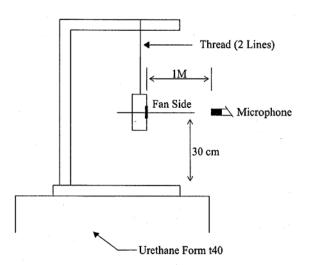
1 METER FROM MICROPHONE TO FAN INTAKE
