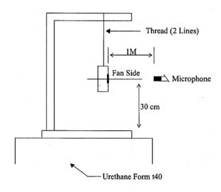
1 METER FROM MICROPHONE TO FAN INTAKE
