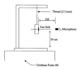
1 METER FROM MICROPHONE TO FAN INTAKE
