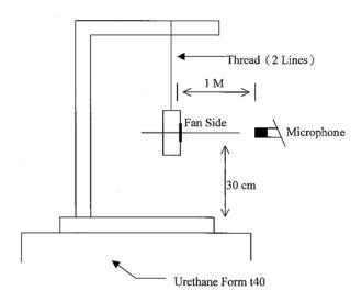
1 METER FROM MICROPHONE TO FAN INTAKE
