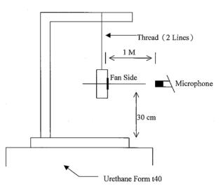
1 METER FROM MICROPHONE TO FAN INTAKE
