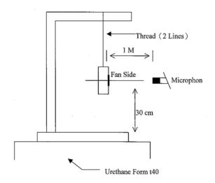
1 METER FROM MICROPHONE TO FAN INTAKE
