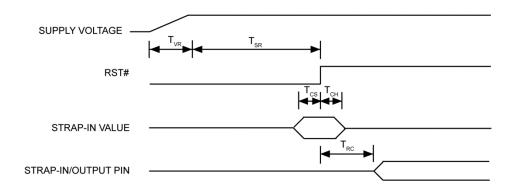
Figure 24. Reset Timing
