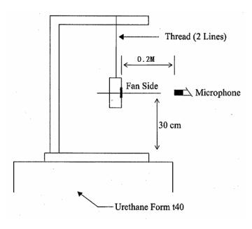
0.2 METER FROM MICROPHONE TO FAN INTAKE
