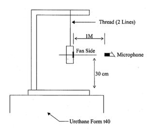
1 METER FROM MICROPHONE TO FAN INTAKE
