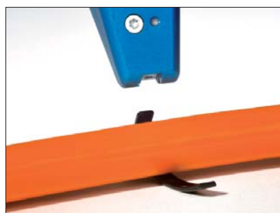
...puść przycisk popychacza i odłóż narzędzie. Opaska jest rozcięta.
