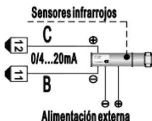
Para señales normalizadas de corriente  $0 \div 20 \text{ mA}$  o  $4 \div 20 \text{ mA}$  con sensores con alimentación externa. Respete la polaridad:
